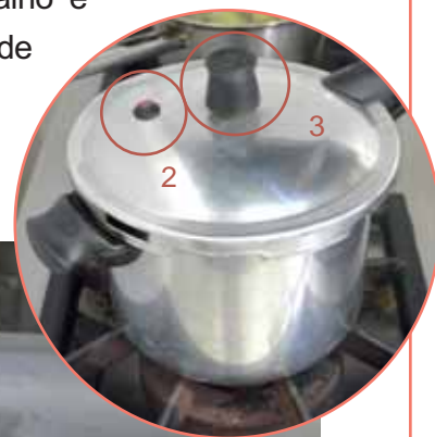
Figura 45 – panela de pressão: 1. nível máximo. 2. válvula de segurança. 3. pino.
